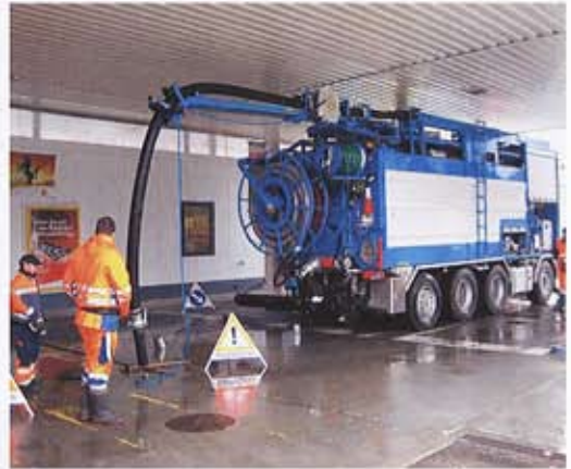
Die speziell für den Schweizer Markt entwickelten Spezialfahrzeuge MAK (Mobile Abscheiderklärung und Konditionierung) sind eine Art mobile Kläranlage für flüssigen Abfall.
